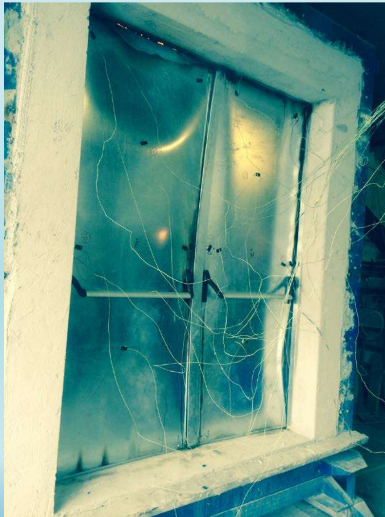
Izgled i deformacije vrata VZV-2/90 i pad uzorka
