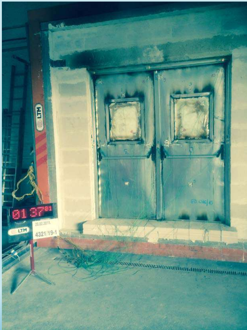
Izgled i deformacija vrata nakon 97 min.
