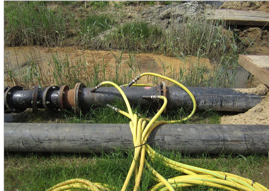
Ubrizgavanje polimera (omjer doziranja ~ 1 kg/t DS)
