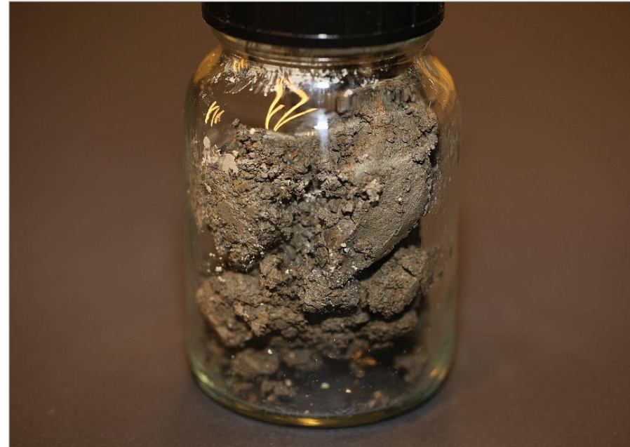
Lučki talog nakon uklanjanja vode (DS nakon 6 mjeseci između 46 % do 56 %)
